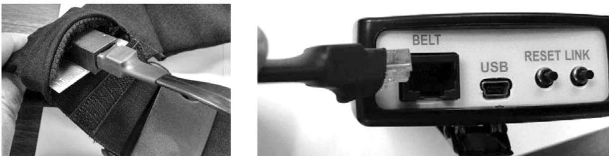
Abbildung 8.4. Verbinden der Box des taktilen Aufnehmers mit dem Gurt.
