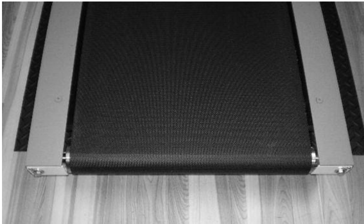
Image 9.9. Arrière du tapis roulant pour montrer l'emplacement du boulon de tension.
