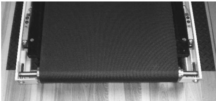
Image 9.10. Boulons à tête hexagonale permettant de régler la bande à gauche ou à droite.
