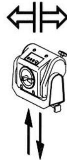
**HINWEIS:** Ausgewuchtet wird das Gewicht des Dynamometers durch eine pneumatische Baugruppe im Befestigungsposten. Wenn der Verriegelungsgriff gelöst wird, kann das Dynamometer dazu neigen, sanft zu steigen oder zu fallen, abhängig vom Gewicht der an der Welle befestigten Anbauteile. Nach dem Einstellen der richtigen Höhe muss der Feststellgriff immer fixiert werden.
