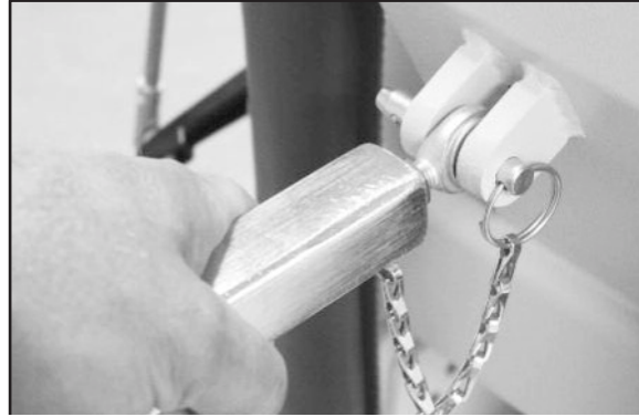
Figure 2.4. Fixation du renfort de dossier de siège au maillon d'attache du dossier de siège du Système 4.
